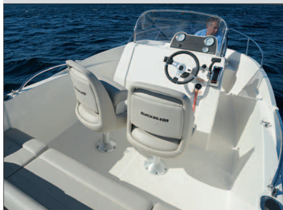
Les extrémités des assises des deux sièges pilote et copilote se relèvent.
