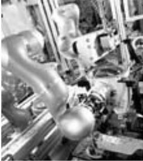
Der KUKA Leichtbauroboter bei der Montage von PKW-Hinterachsgetrieben.
