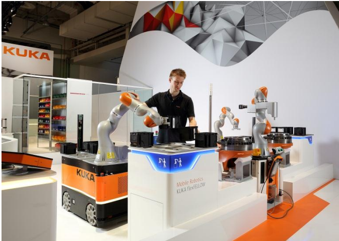
KMR iiwa Mobiles, autonomes Robotiksystem
