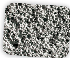
POROFLOW® F lité směs na bázi cementu a technické pěny
