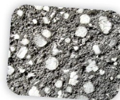
POROFLOW® FS lité směs na bázi cementu, technické pěny a polystyrenového granulátu
