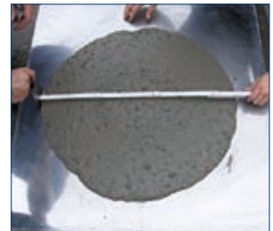
Vysoký stupeň rozlívání betonů řady COMPACTON®
