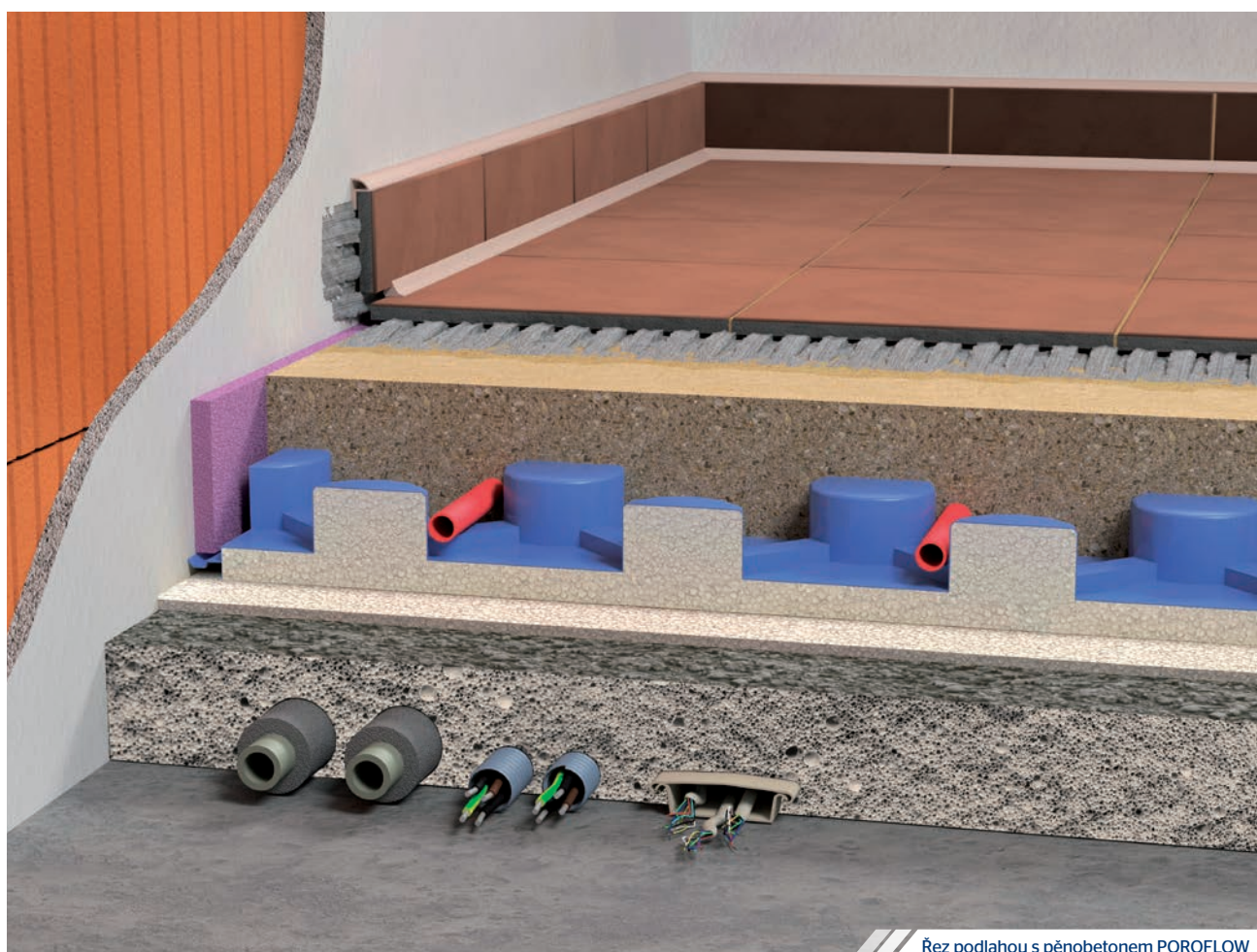
Řez podlahou s pěnobetonem POROFLOW
